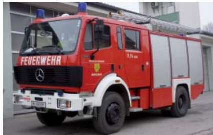
TLF 4000 Tanklöschfahrz. 4000l Mercedes 1227 4x4 12 t Bj. 1994 Brandbekämpfung. 4000 l Wassertank, Schaummittel, Atemschutzgeräte, Wasserwerfer.
