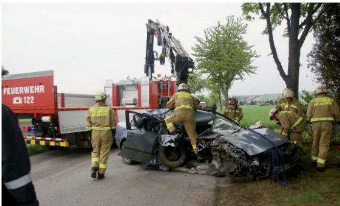
Fahrzeugbergungen mit dem Rüstlösch- und Wechselladefahrzeug (RLF + WLF) nach Verkehrsunfällen. Das Duo RLF + WLF hat sich dabei bestens bewährt. Das Unfallauto wird entweder mit dem Ladekran oder mit der eingebauten Seilwinde des WLF auf das Plateau verfrachtet.
