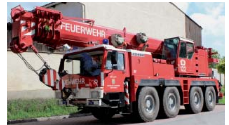
KRAN Kranfahrzeug Liebherr LTM 1070 48 t, 408 PS Bj. 1998 LKW-Bergung u. Katastropheneinsätze überregional. 50t Kran, 20t Seilwinde *NÖ LFV - stationiert bei FF Mistelbach
