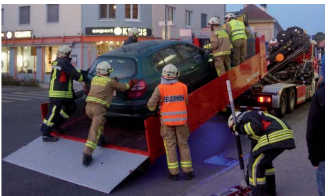
Fahrzeugbergungen mit dem Rüstlösch- und Wechselladefahrzeug (RLF + WLF) nach Verkehrsunfällen. Das Duo RLF + WLF hat sich dabei bestens bewährt. Das Unfallauto wird entweder mit dem Ladekran oder mit der eingebauten Seilwinde des WLF auf das Plateau verfrachtet.
