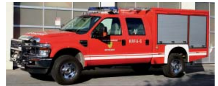
Voraus Vorausrfahrzeug Ford F 350 4x4 6 t, 360 PS Bj. 2008 Menschenrettung, Techn. Hilfeleistung. 200l Wassertank, Schaummittel, Berge- und Schneidewerkzeug, Beleuchtung.
