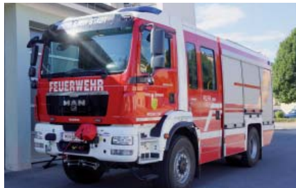
RLFA 2000 Rüstlöschfahrz MAN TGM 18.340 4x4 18 t Bj. 2013 Brand- und Technische Einsätze. 2000 l Wassertank, Schaummittel, Atemschutz- geräte, Wasserwerfer, Druckbelüfter, hydrau- lisches Rettungsgerät, Lichtmast, Seilwinde
