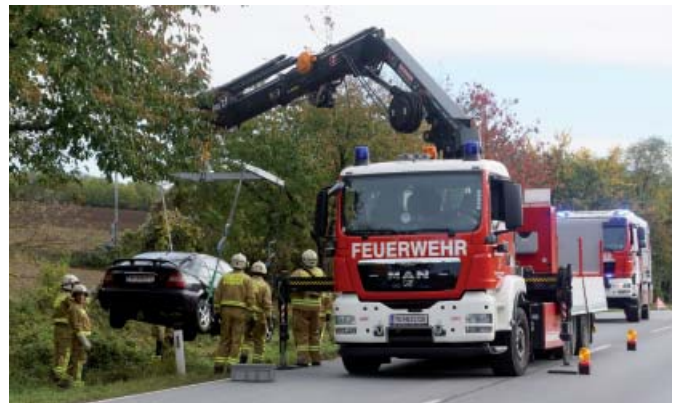
Fahrzeugbergungen mit dem Rüstlösch- und Wechselladefahrzeug (RLF + WLF) nach Verkehrsunfällen. Das Duo RLF + WLF hat sich dabei bestens bewährt. Das Unfallauto wird entweder mit dem Ladekran oder mit der eingebauten Seilwinde des WLF auf das Plateau verfrachtet.
