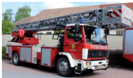
Leiter Drehleiter Höhe 30m Mercedes 1524 14 t Bj. 1997 Höhenrettung, Brandbekämpfung
