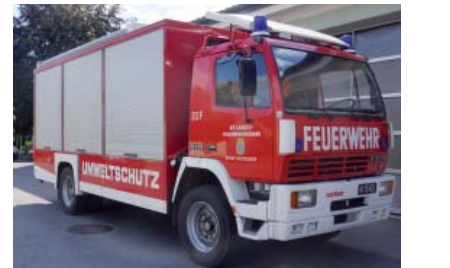
STF Schadstofffahrzeug Steyr 12 S 21 12 t Bj. 1989 Umweltschutz- u. Schadstoffeinsätze im ges. Bezirk. Schutzausrüstungen und Geräte für chemische Einsätze. **BFKDO - stationiert bei FF Mistelbach
