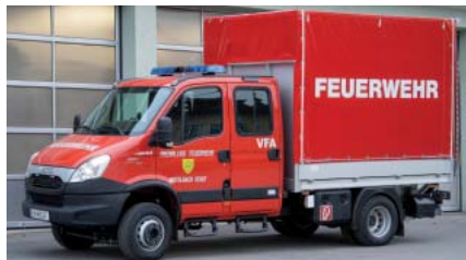
LAST Pritsche mit Planenaufbau IVECO Pias 4x4 5,5 t Bj. 2013 Transport- und Begleitfahrzeug bei Kran- u. sonst. technischen Einsätzen.
