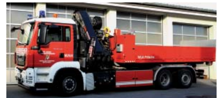
WLF m. Kran Wechselladefahrz MAN TGM 26.400 26 t Bj. 2010 Transport- und Technische Einsätze. Ladekran, Plateau für Unfallfahrzeuge. *NÖ LFV - stationiert bei FF Mistelbach
