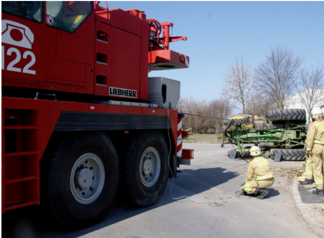
Der umgestürzte Traktor wurde mit den Seilwinden von Kran und Rüstfahrzeug aufgestellt.
