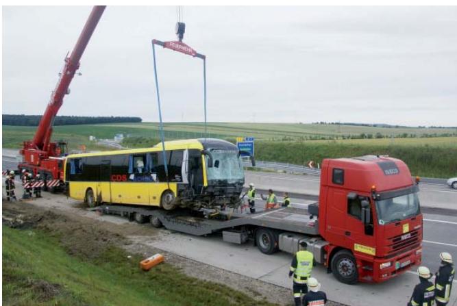
A5: Autobus-Bergung mit dem 50 t Kran Autobus ist von der Fahrbahn abgekommen und hat die Leitschiene durchbrochen. Fahrgäste sind nicht zu Schaden gekommen. FF Mistelbach, FF Hochleithen
